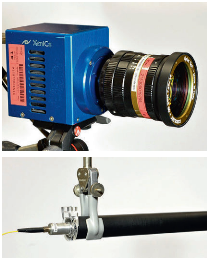
Bild 6: Die verwendete Hardware: Xenics Xeva-1.7-320 Infrarot-Kamera und SemiNex 4PN-108 1550 nm Laserdiode
